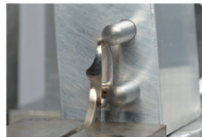
Abb. 2: Dauerversuch: Manschettenknopfmechanik in Endlage 2
