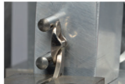
Abb. 1: Dauerversuch: Manschettenknopfmechanik in Endlage 1
